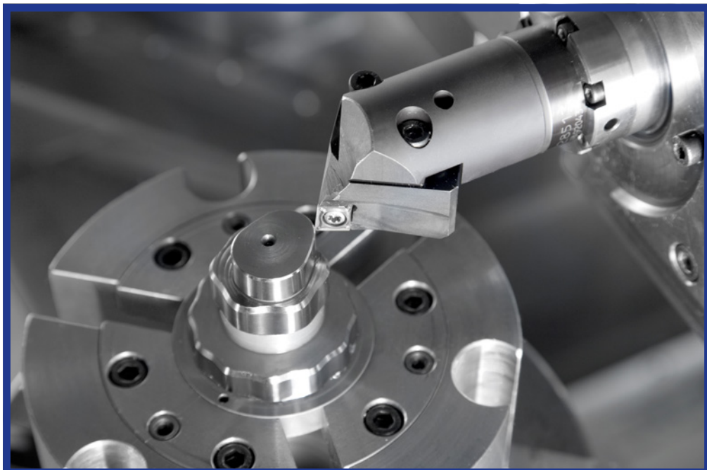
Unrundbearbeitung eines Getriebeteils
